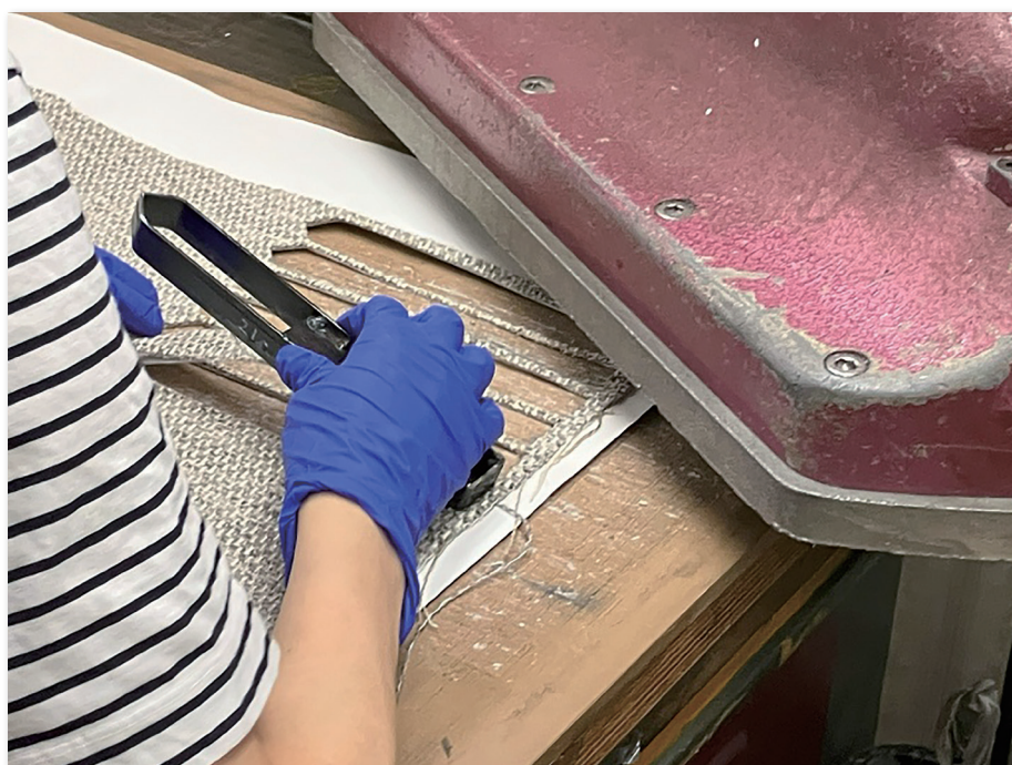
▲製作過程（専用金型で型抜き）
